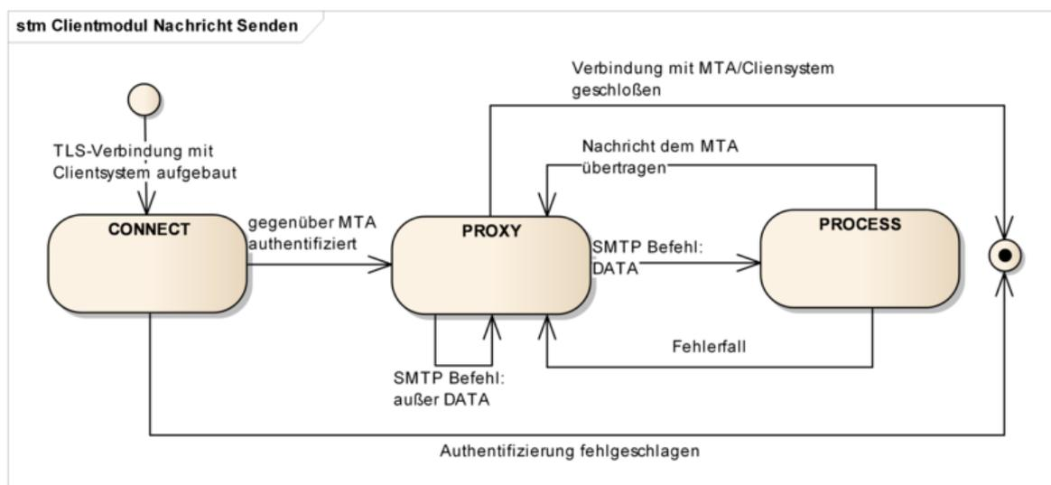
**Abbildung 6: Abb\_State\_CM\_Send Zustände Clientmodul beim Senden von Nachrichten**
