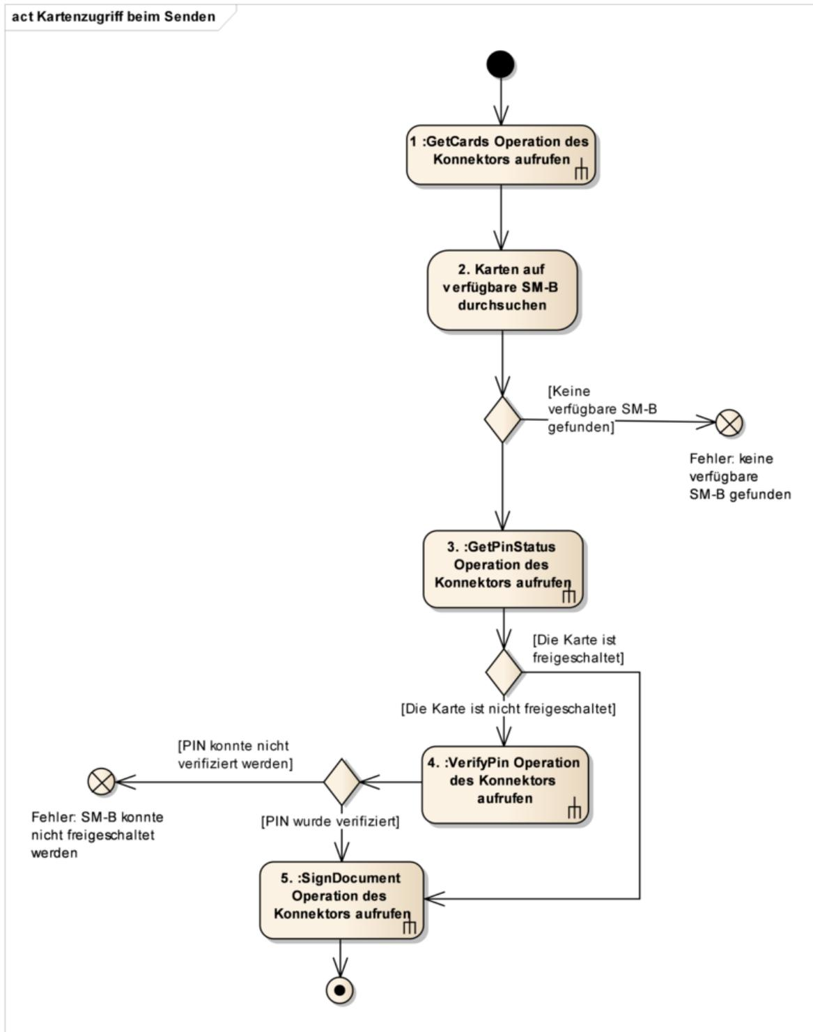
Abbildung 13: Abb\_Zugriff\_SMB SM-B-Zugriff zur Erstellung der Nachrichtensignatur
