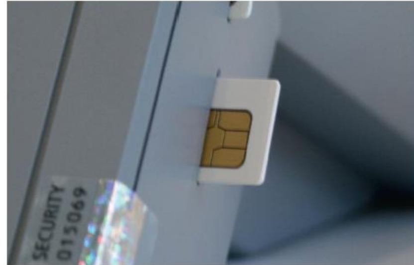
Für den Zugang zur Telematikinfrastruktur muss die Karte SMC-B in ein eHealth-Kartenterminal eingesetzt werden. Entweder full-size in Slot 1 („eGK-Slot“) oder nach Herausbrechen der ID-000-Karte in den SMC-B-Slot.
